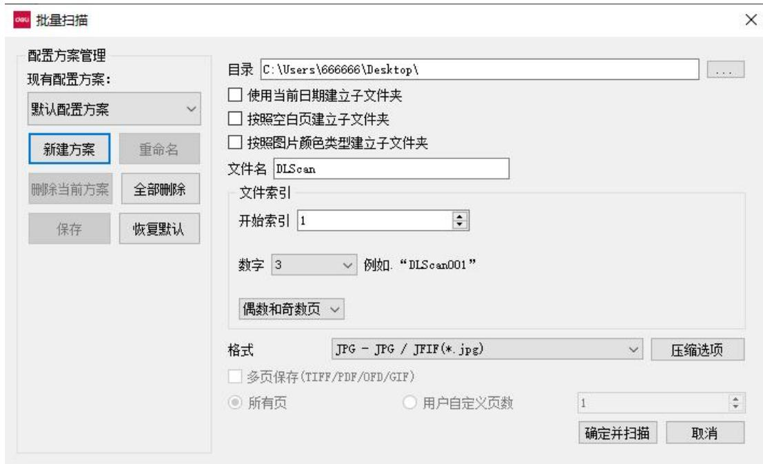
设置好参数后，点击“确定并扫描”按钮，扫描仪将进行批量扫描。扫描到的图像都将自动储存在指定的目录中。
