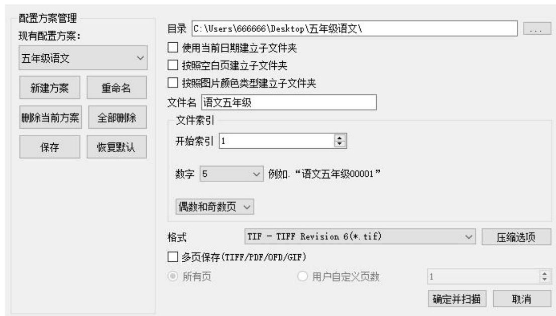
用户可将扫描路径、文件名、图片格式等参数保存为自定义配置，以便快速切换选择使用。在应用程序主界面的工具栏存在相同的配置方案下拉菜单。
