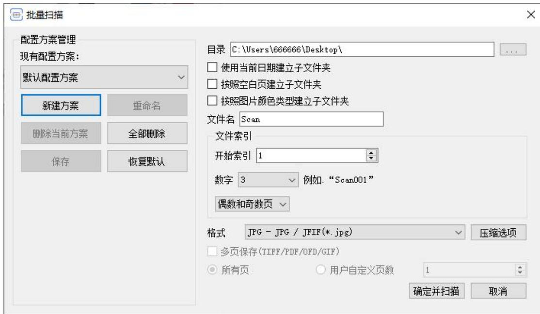
设置好参数后，点击“确定并扫描”按钮，扫描仪将进行批量扫描。扫描到的图像都将自动储存在指定的目录中。
