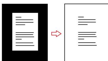
**高级参数设置：**可对图像中真实文稿边缘的判定算法进行参数设置。不勾选时，图像处理算法将自动采用默认值进行图像处理。
