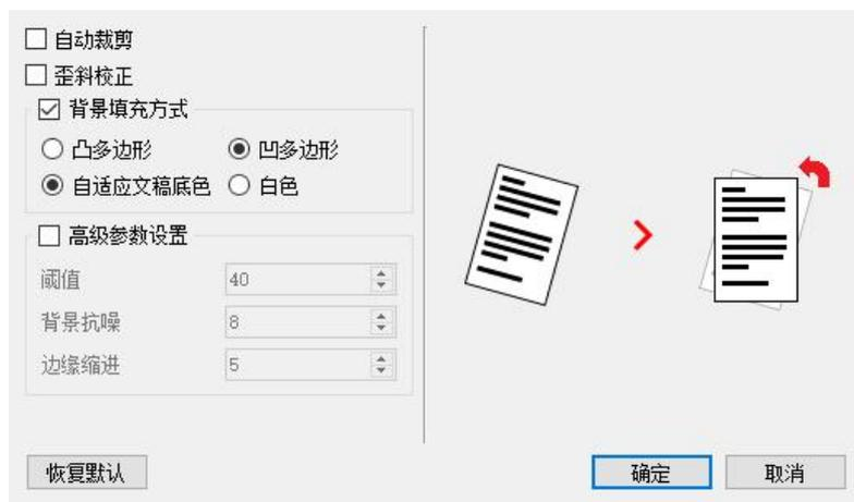
**自动裁剪：**判断图像中真实文稿的边缘并自动对图像进行裁剪，使得图像贴合文稿真实边缘。
