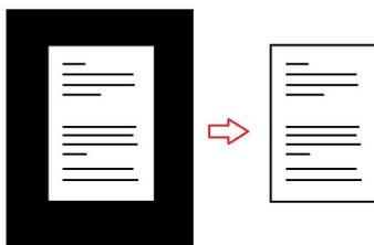
**歪斜校正：**判断图像中真实文稿的倾斜程度并自动对图像进行旋转，使得文稿真实边缘变为横平竖直。
